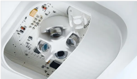
4 pyrodétecteurs numériques avec DSP (Digital Signal Processing)
