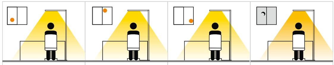
Dank beruehrungsgesteuerter Dimmung kann die gewuenschte Helligkeit manuell angepasst werden. Die Leuchte uebernimmt automatisch den so definierten Dimmwert als Sollwert. Der integrierte Tageslichtsensor passt unter Beruecksichtigung des eingestellten Dimmwertes die Beleuchtungsstaerke automatisch an die wechselnden Tageslichtverhaeltnisse an.
